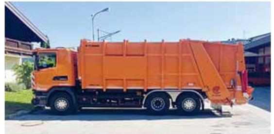
ger LKW mit gelenkter Nachlaufachse und einem Gesamtgewicht von 25.700 kg.
